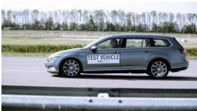
**Bildunterschrift:** Beim AMS-Test ist das Auto mit zwei Personen und Säcken mit Stahlgranulat bis zum zulässigen Gesamtgewicht beladen und wird zehnmal hintereinander aus 100 Stundenkilometern bis zum Stillstand abgebremst.
